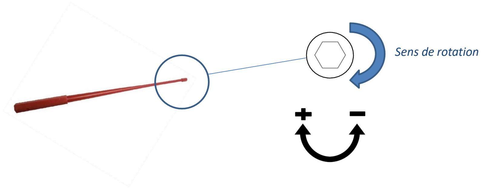
Serrez dans le **sens des aiguilles d'une montre** pour faire **remonter** le volet roulant.
