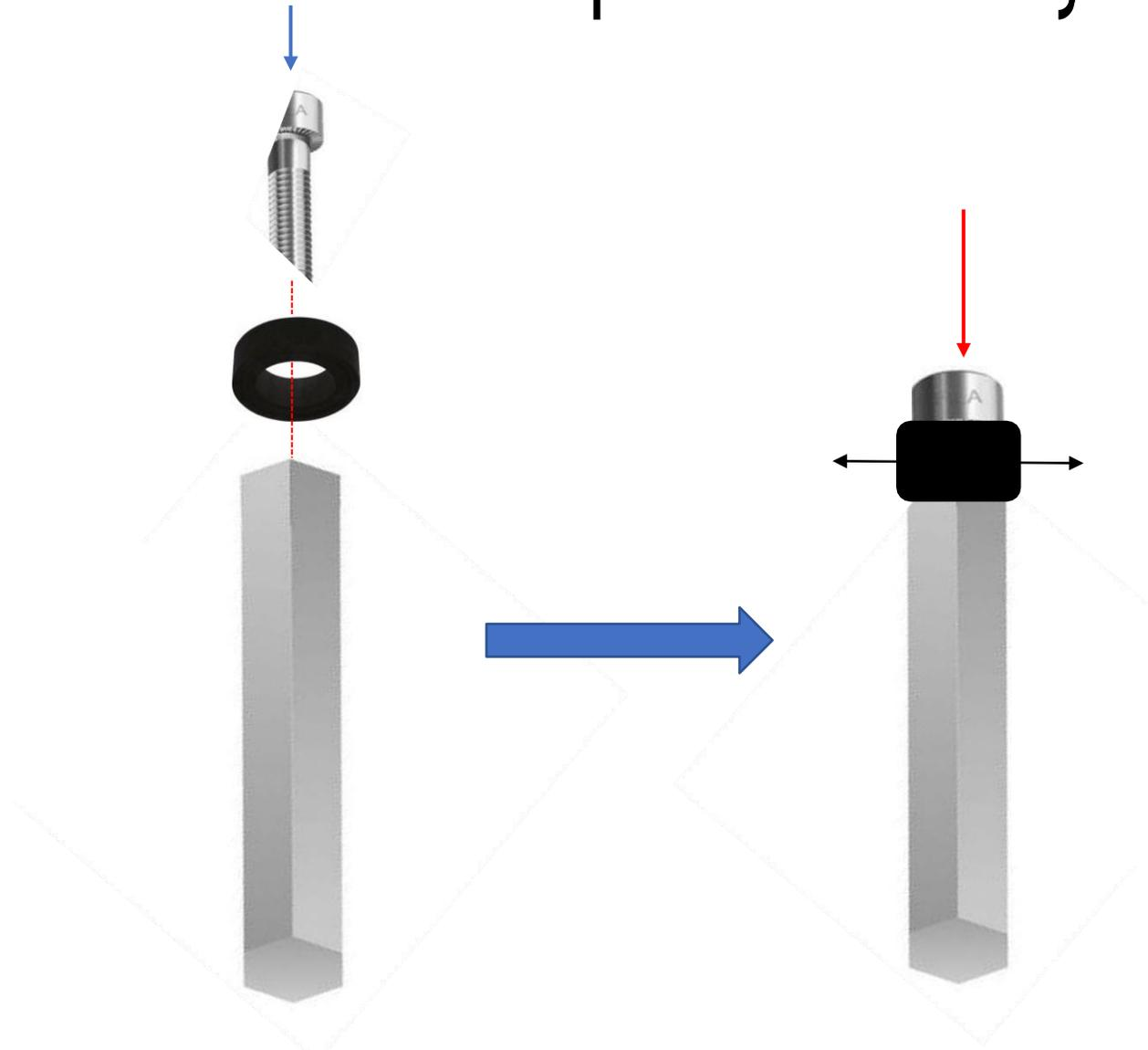
En serrant la vis de compression, le diamètre de l'anneau en caoutchouc augmente. Cela permet, lors de l'insertion de la manœuvre de secours dans le moteur, d'empêcher sa chute lors de l'utilisation. Une fois la fermeture du store effectuée, tirez sur la manœuvre de secours pour la libérer de son logement.
