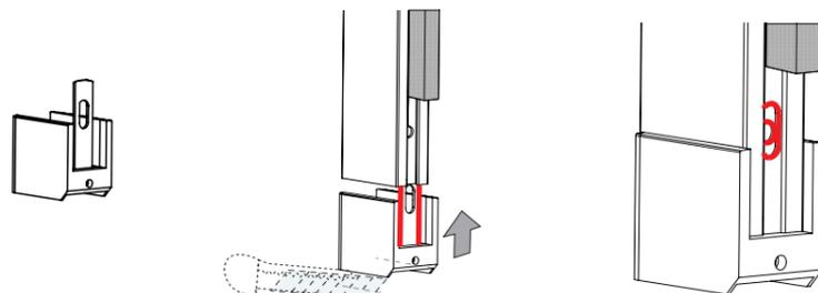
Si besoin, recouper à l'aide d'un cutter pour rattraper l'inclinaison de l'appui de fenêtre
