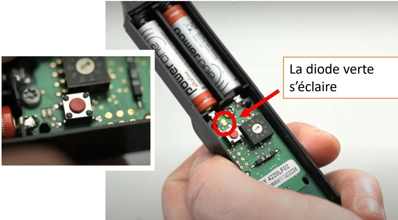
Par défaut, le potentiomètre est réglé au seuil 2. Si à l'utilisation, ce seuil s'avérait trop sensible, vous pourrez l'augmenter graduellement.
